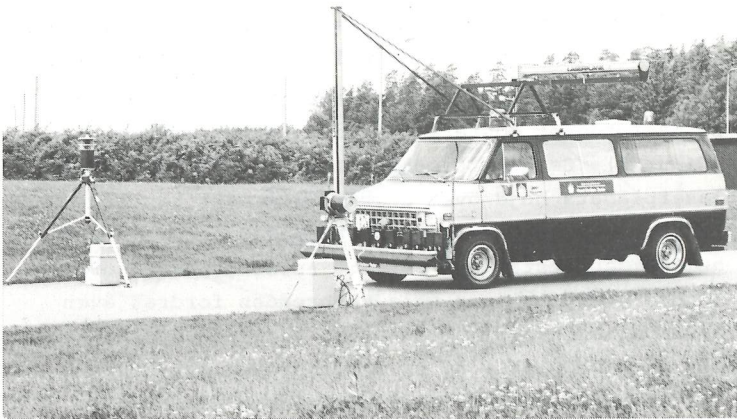
Figur 5 VTI Laser RST. Utrustning för tredimensionell uppmätning av provvägar och rullbanor
