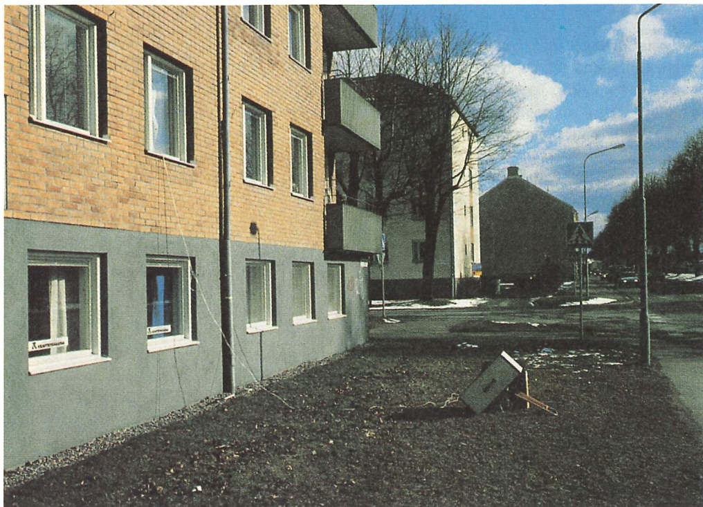
Mätning av ljudisolering i fasad med högtalare, som bl a kan resultera i ...
