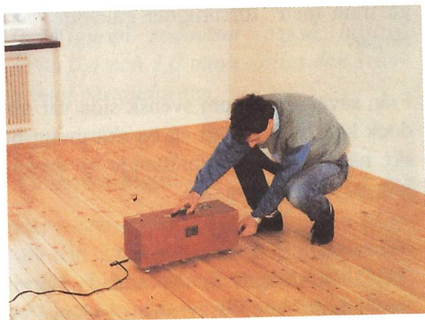
Stegljudsmätning med hammarapparat
