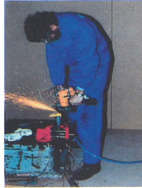
Fig. 1 Exempel på en slipmaskin som undersöks med running mode analys för att se om den kan betraktas som en stel kropp.
